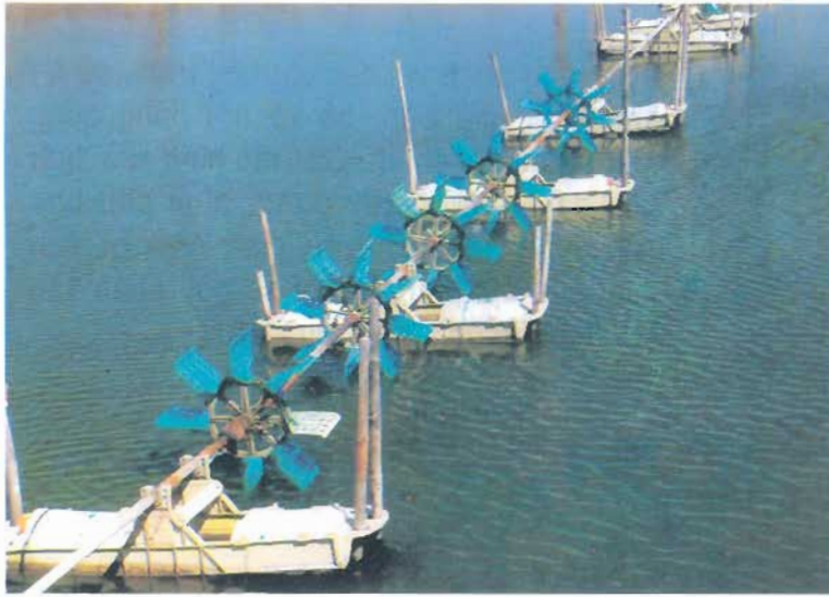
Quạt nước trang bị trong ao nuôi tôm thâm canh dự án đầu tư con giống tại Cà Mau
