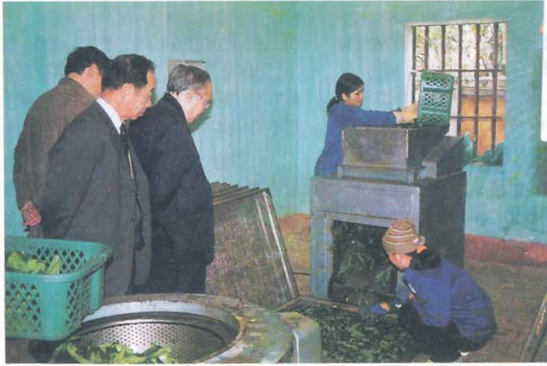
Bộ phận ly tâm nước, cắt thô xưởng chế biến chè đẳng Cao Bằng
